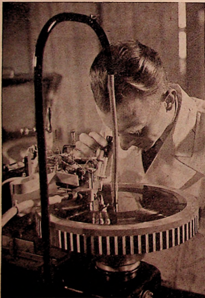
Boven: Een „vadermatrijs“, vervaardigd door het neerslaan van zilver op de lakplaat, komt uit het zilverbad. Onder: Tijdens het snijden van de lakplaat worden de groeven nauwkeurig gecontroleerd
