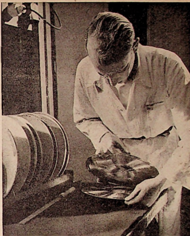
★ Boven: Een positief matrijs wordt van een negatief matrijs gescheiden. — Onder: Het onderzoek van mechanische eigenschappen van grondstoffen waaruit gramfoonplaten worden geperst.
