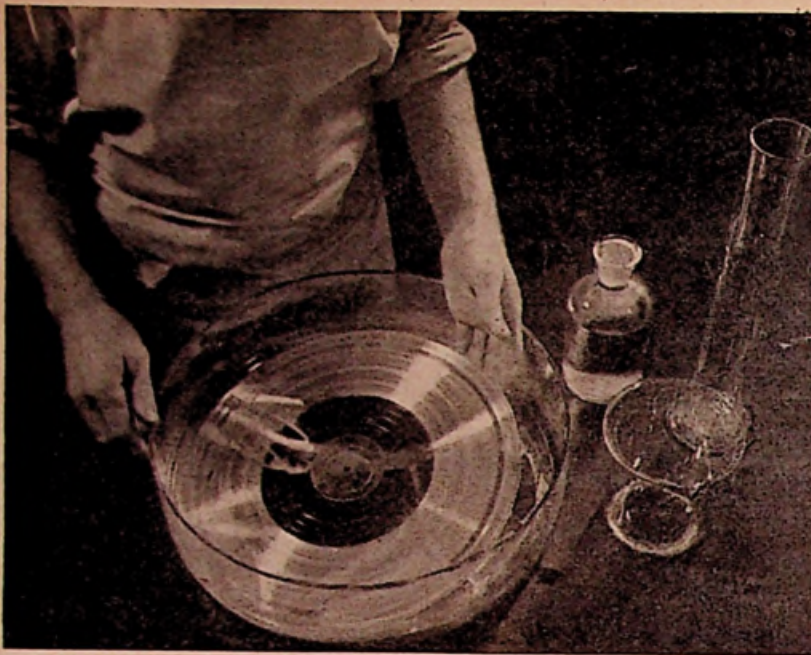
Boven: Een „vadermatrijs“, vervaardigd door het neerslaan van zilver op de lakplaat, komt uit het zilverbad. Onder: Tijdens het snijden van de lakplaat worden de groeven nauwkeurig gecontroleerd
